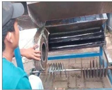
(e). Pemasangan screw
